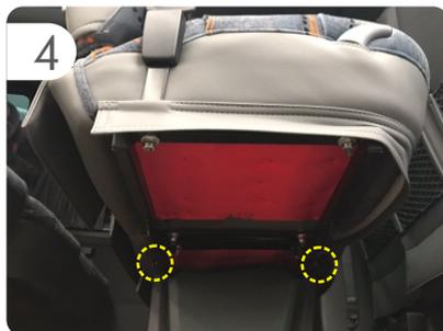
Localizar os dois pontos de fixação dos parafusos.
