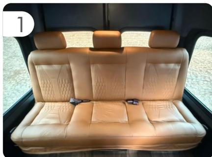
Na entrega do veículo, o sofá-cama é disponibilizado travado na posição mais ao fundo do trilho. Para evitar o contato do revestimento com as colunas traseiras, primeiramente o sofá-cama deve ser deslizado para frente.
