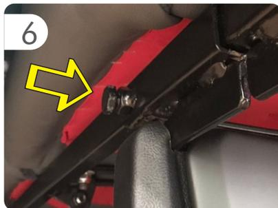
Inserir e apertar o parafuso traseiro utilizando uma chave de boca 17mm.
