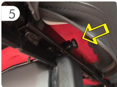
Inserir e apertar o parafuso frontal utilizando uma chave de boca 17mm.
