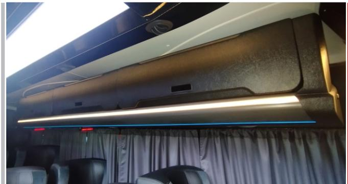
Na versão com portas em ABS, nosso maleiro vem equipado com um mecanismo de abertura e fechamento. Para facilitar o manuseio, utilize o puxador conforme demonstrado na imagem abaixo.
