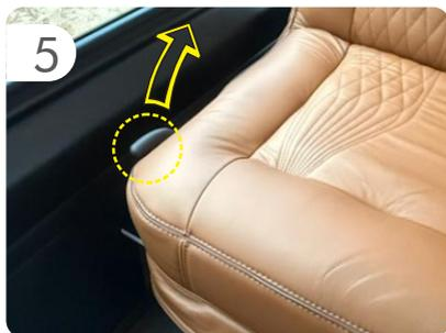
Altere entre os lados puxando os manipulós laterais para trás, enquanto empurra o encosto para a posição completamente reclinada.
