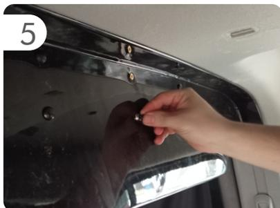
5 Fixar os parafusos utilizando uma chave Philips e reposicionar os acabamentos.
