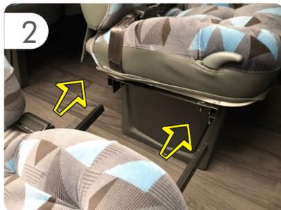
Inserir banco removível nos orifícios da base até que ele se conecte completamente.
